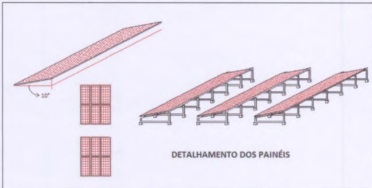
*Figura 3 - Detalhamento para instalação dos painéis.*
